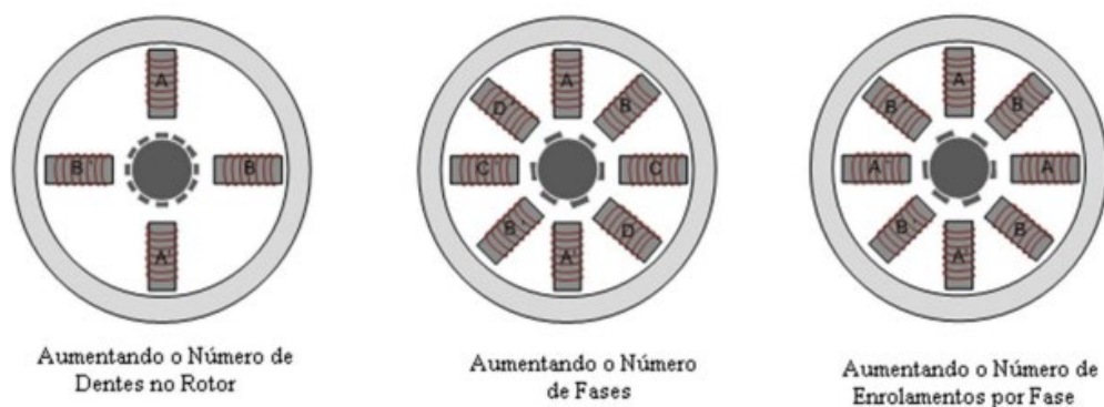
Figura 24: formas de aumento da resolução de um motor de passo de Relutância Variável.
