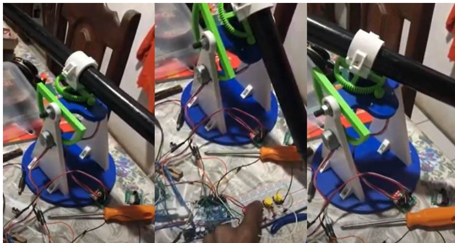
Figura 45: a luneta no dispositivo, à esquerda, com altura e ascensão reta estabilizadas em posições neutras do suporte, ao centro, com declinação alterada, e à direita, com ascensão reta alterada.
