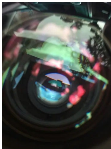
Figura 6: efeito da aberração cromática
